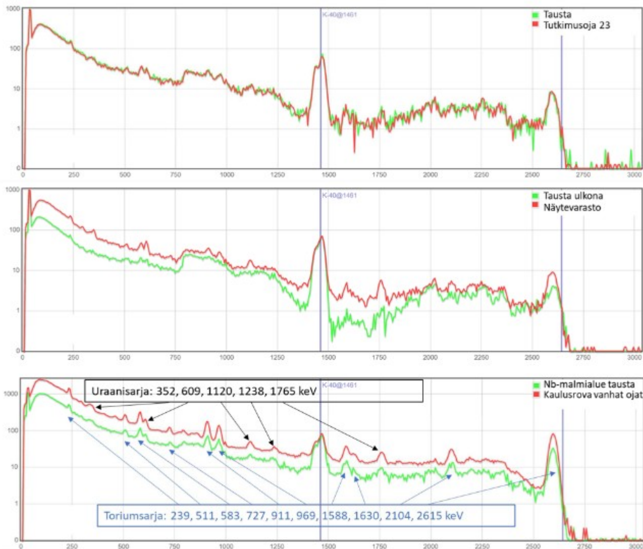
Kuva 2. STUKin tarkastuksella 5.9.2022 mitattuja gammasäteilyn energiaspektrejä Soklista. Sokli Oy:n peitetty tutkimusojat 23 on esimerkki kohteesta, joka ei erotu lähialueen taustasäteilyä (yläkuva). Sokli Oy:n näytevarasto (keskikuva) ja Kaulusrovan niobimalmialueen vanhat tutkimusojat (alakuva) ovat esimerkkejä kohteista, joissa on havaittavissa uraani- ja toriumsarjojen hajoamistuotteista johtuvia fotonipiikkejä, joiden intensiteetti on hieman taustasäteilyä suurempi. Myös niobimalmialueen taustasäteilyn spektrissä on havaittavissa samat fotonipiikit, mutta pienemmällä intensiteetillä kuin omissa. Energiat ovat merkittynä näkyviin vain alimpaan kuvaan. Suuri piikkiyhdistelmä 1438–1461 keV kohdalla johtuu kalium-40:stä sekä ilmaisimen kiteen sisältämästä lantaani-138:sta.
